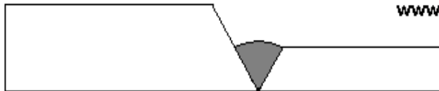
Soldadura en " V "
